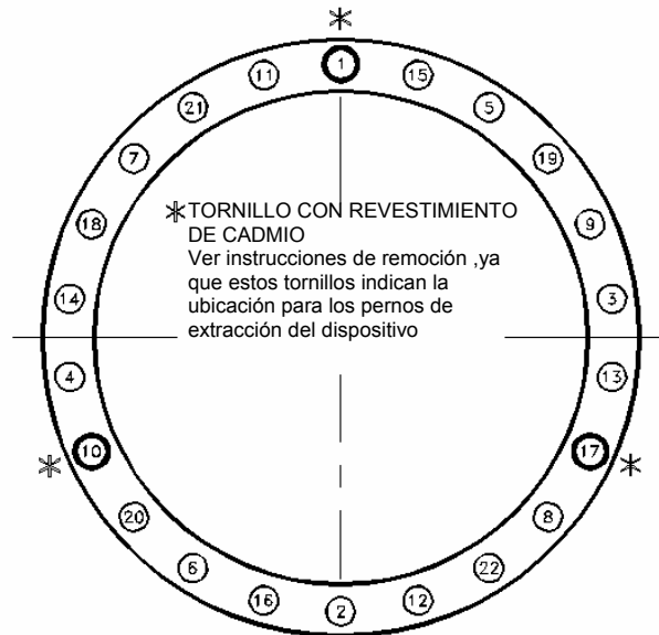
FIGURA 5 SECUENCIA DE APRIETE DEL RINGFEDER DE LA POLEA
